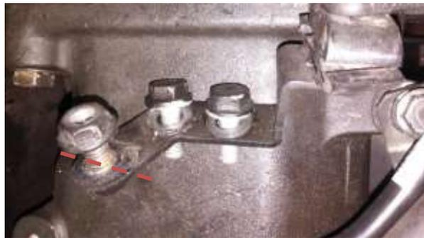
3. При подводе топлива от электронного блока управления (ЭБУ) Bosch EDC7 к топливopодкачивающему насосу ТНВД А-08-004-00-00-01 требуется установить топливопровод 740.70-1104258-50 (1) и штуцер 570.70-1104327-10 (2).
